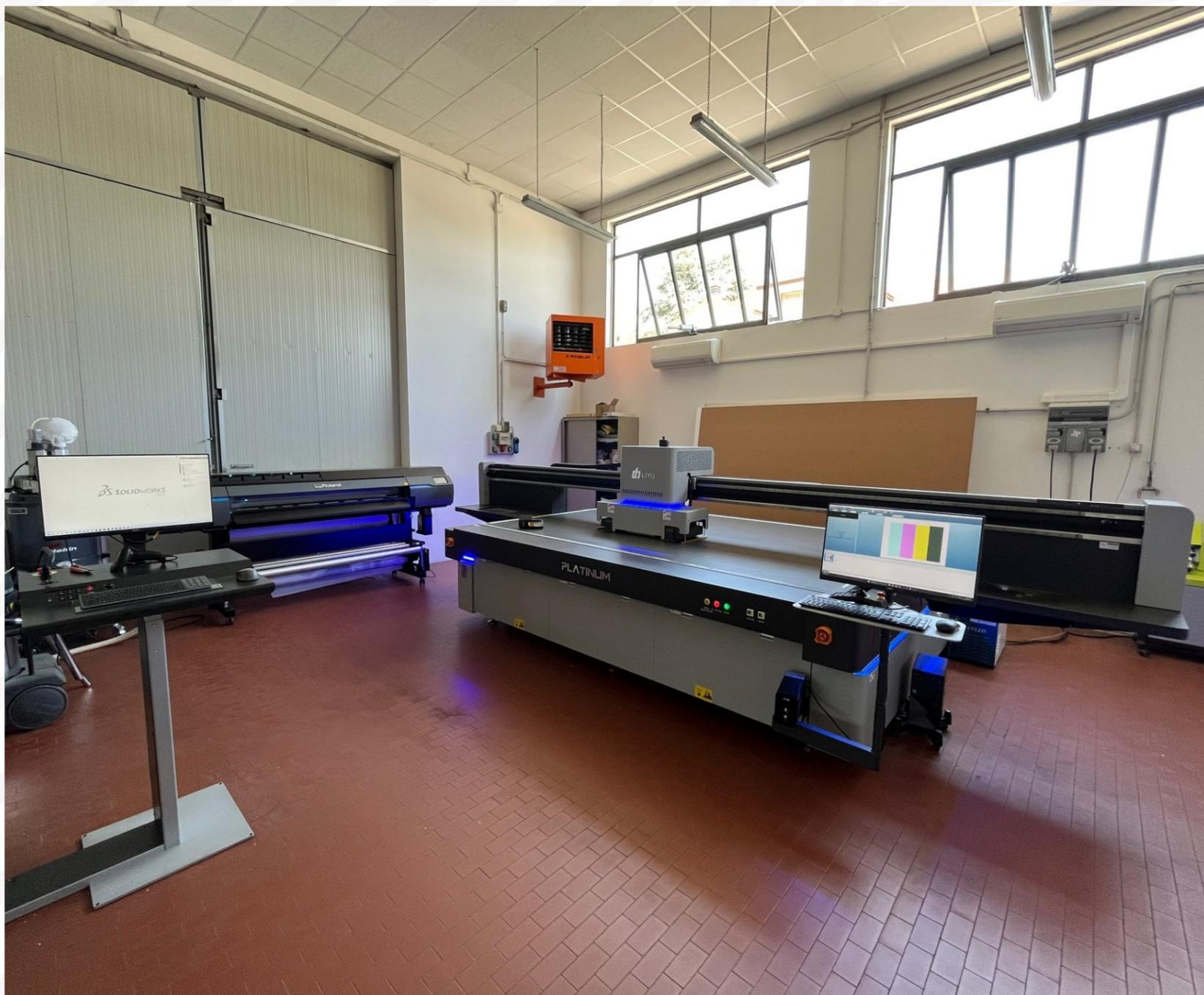
Abbiamo creato un reparto di stampa digitale, pulito e climatizzato in cui realizzare prototipi, campionature e piccole produzioni per il quale sono stati acquistati un plotter digitale a rotolo Roland, un plotter Liyu UV LED piano di grande formato, una licenza Solidworks per la stazione CAD, uno spettrofotometro di ultima generazione
